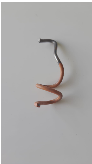
Figure 2: Résultat final du cuivrage du fil d'étain.
