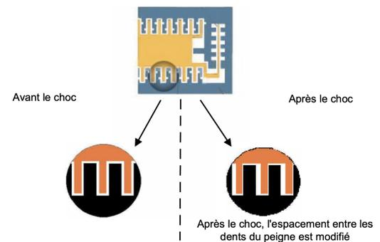
Figure 3: Fonctionnement du condensateur intégré dans un airbag
