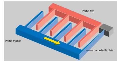
Figure 2: Principe de fonctionnement d'un capteur capacitif
