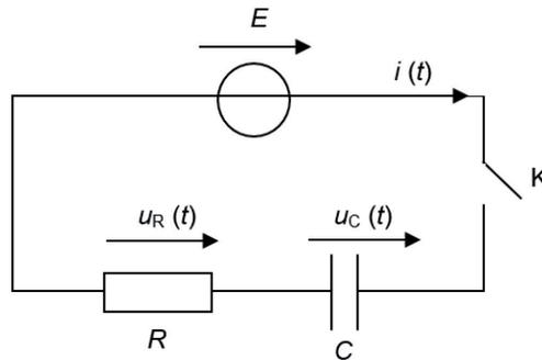
À la date  $t = 0$  s, le condensateur est déchargé et on ferme l'interrupteur. On souhaite établir l'expression de la tension  $u_C(t)$  aux bornes du condensateur.
