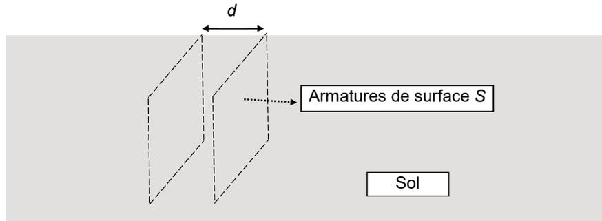
Figure 1. Schéma simplifié du condensateur d'un détecteur d'humidité
