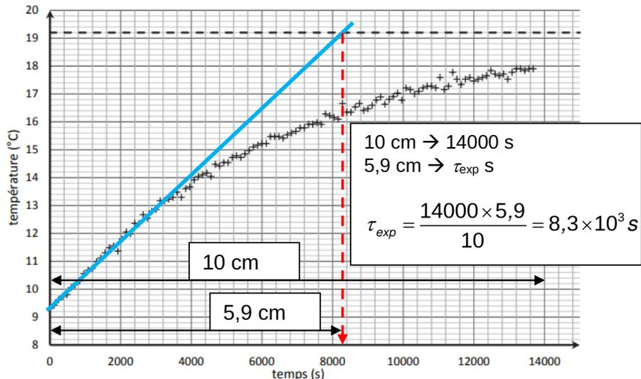
Figure 2. Mesures expérimentales de la température du bloc de tomate
