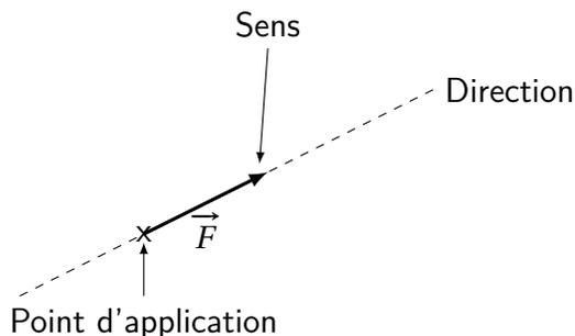
L'intensité d'une force se note  $F_{\text{auteur/receveur}}$ , elle se mesure à l'aide d'un dynamomètre et s'exprime en **newton** (symbole : N). Le vecteur correspondant se note  $\vec{F}_{\text{auteur/receveur}}$ .
