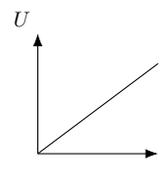
Aux bornes d'un dipôle ohmique ou d'une résistance, la tension  $U$  est proportionnelle à l'intensité du courant  $I$  qui la traverse, et le coefficient de proportionnalité est la valeur de la résistance  $R$ :
