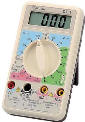
L'appareil ci-contre est un multimètre permettant de mesurer ces grandeurs:
