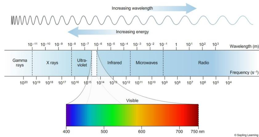
Figure 1: Place de la lumière visible dans le spectre de la lumière.
