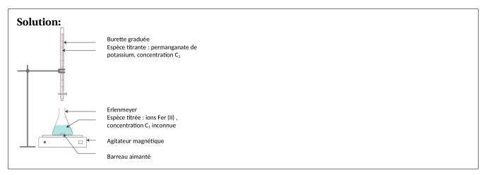
Lors du titrage réalisé, l'équivalence est obtenue pour un volume versé  $V_{eq} = 9.5 \,\mathrm{mL}$  de la solution de permanganate de potassium.
